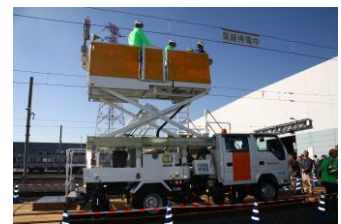
△軌陸両用型架線作業車 体験乗車
